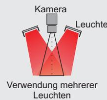
Eine zur Arbeitsfläche schräg gestellte Leuchte erzeugt je nach Winkel und Abstand physikalisch bedingt ggf. ein etwas inhomogenes Leuchtfeld. Durch eine symmetrische Anordnung mehrerer Leuchten kann dieser auftretende Lichtabfall ausgeglichen und zusätzlich eine höhere Lichtintensität im Arbeitsbereich erreicht werden.
